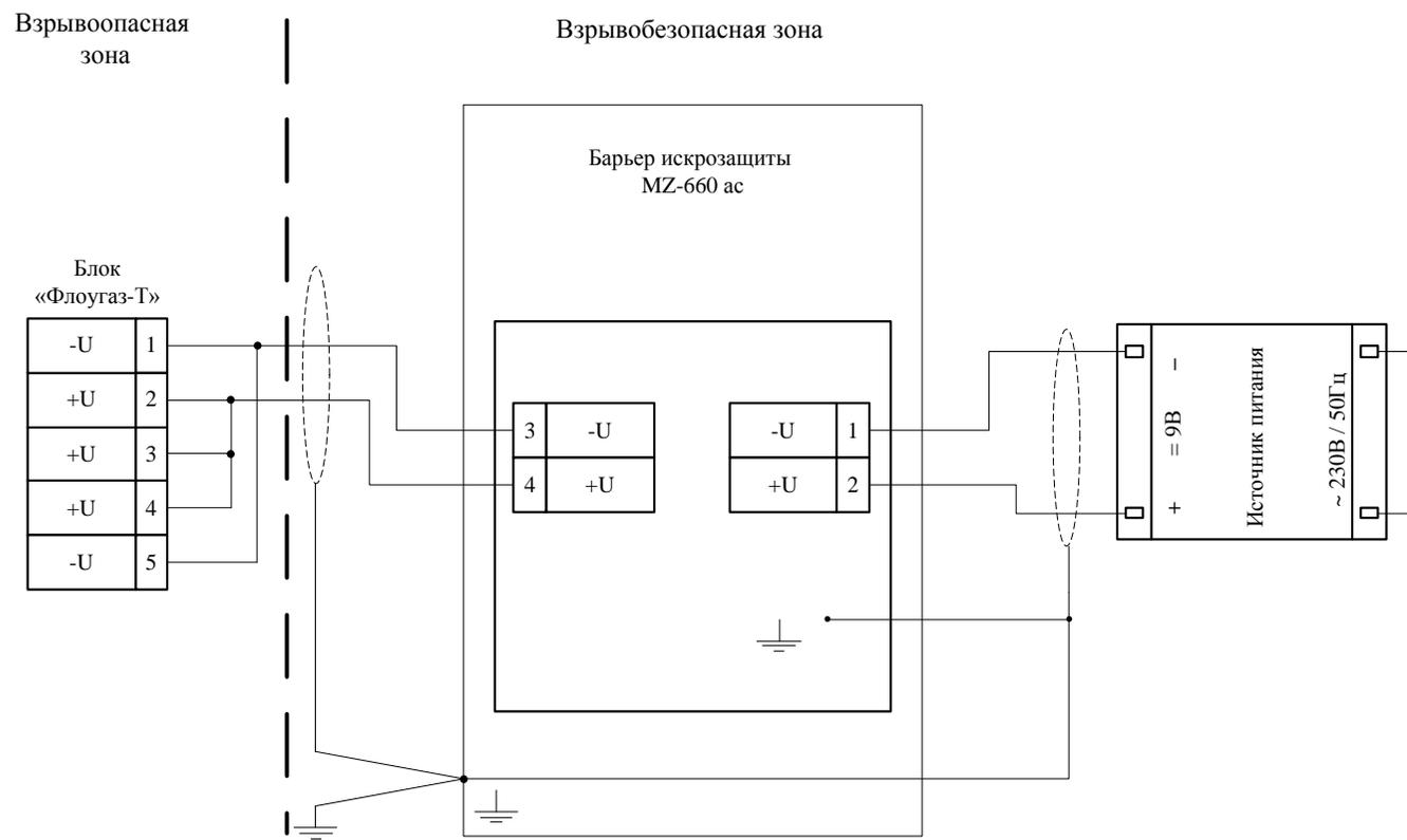
Рисунок Б 5 Схема подключения внешнего источника питания во взрывоопасной зоне
