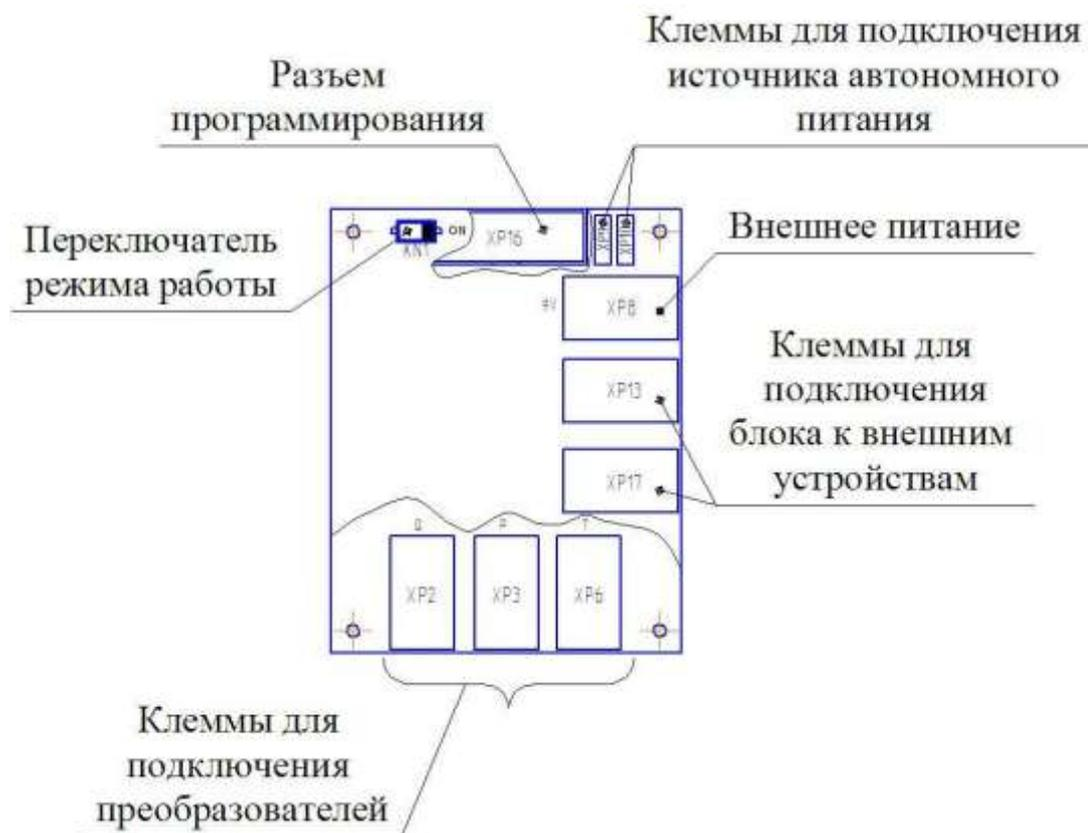
Рисунок Б 1 Расположение и маркировка клемм монтажной платы для подключения преобразователей и внешних устройств
