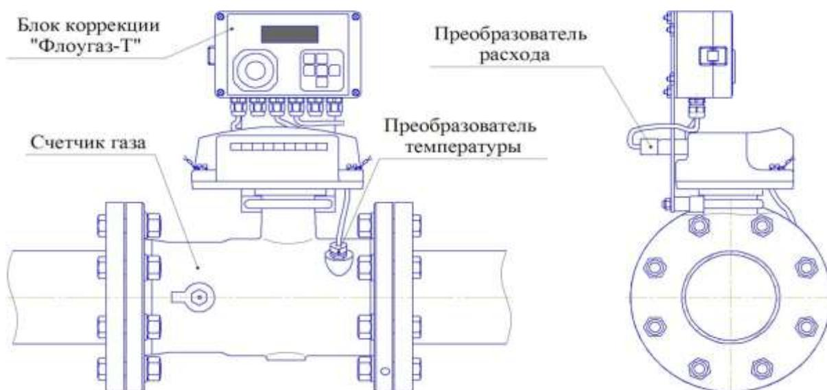
Рисунок 3 Монтаж блока «Флоугаз - Т» на счетчик СТГ
